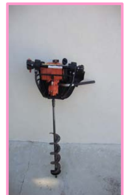
Trarière thermique pour mise en place de notre cep motte
